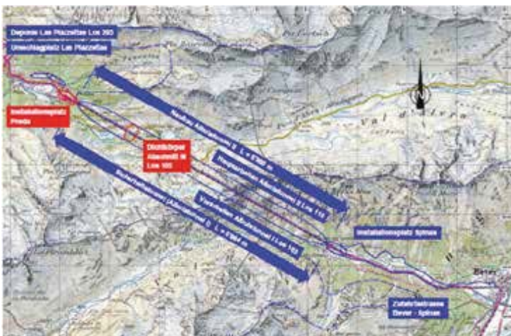
Trasse des neuen Albulatunnels II mit ca. 30 m Abstand zum bestehenden Tunnel.
